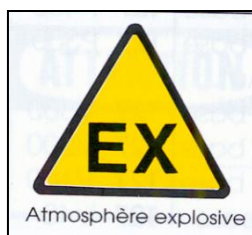
Signalétique du zonage ATEX
